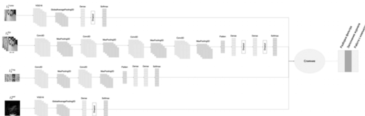
Рисунок 3 – Архитектура модели позднего слияния в рамках разрабатываемого решения
