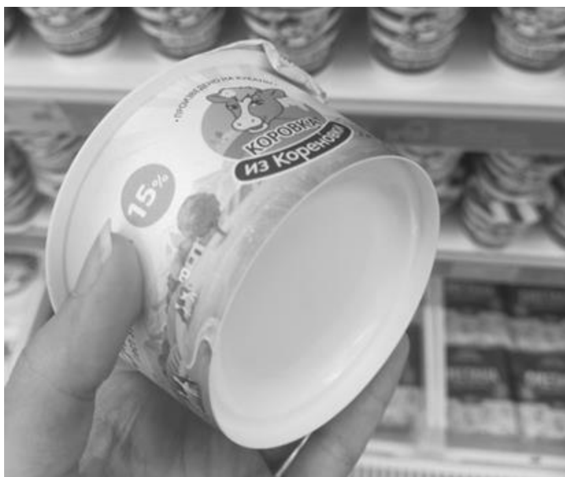
Рисунок 4 – Пример продавленного дна
