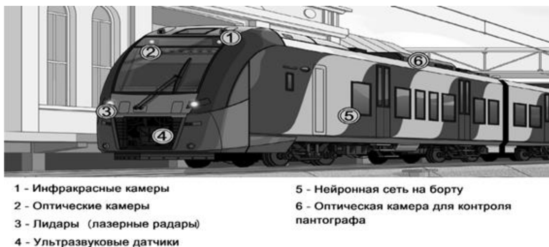
Рисунок 1 - Используемые системы контроля на беспилотной «Ласточке» (подготовлен авторами)
