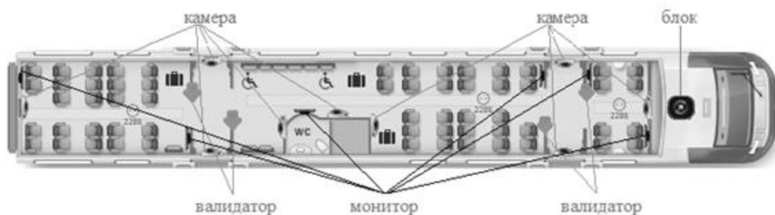
Рисунок 3 - Предполагаемая схема компоновки «Умной электрички» (подготовлено авторами)
