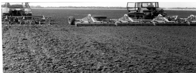
Рисунок 3 - Культиватор КБМ обеспечивает стопроцентное выравнивание поверхности поля (справа). Общепринятый по всей России культиватор КПС-4+4БЗСС-1+шлейфы не обеспечивает условий сохранения влаги, гребнистость – 7 см, равномерной заделки семян, их дружной всхожести, образования вторичных корней и кущения, допустив потерю половины потенциального урожая (слева). Таким же и более недостатком обладает зарубежный аналог – культиватор «Horsch»
