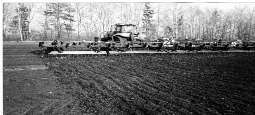
Рисунок 4 - Культиватор «Horsch» оставляет за собой глыбистую, гребнистую (до 11 см) поверхность, недопустимую по агротехнике возделывания зерновых культур в России, и за несколько дней удаляет запасы влаги и тепла в почве как радиаторная поверхность, что приводит к резкому снижению урожайности
