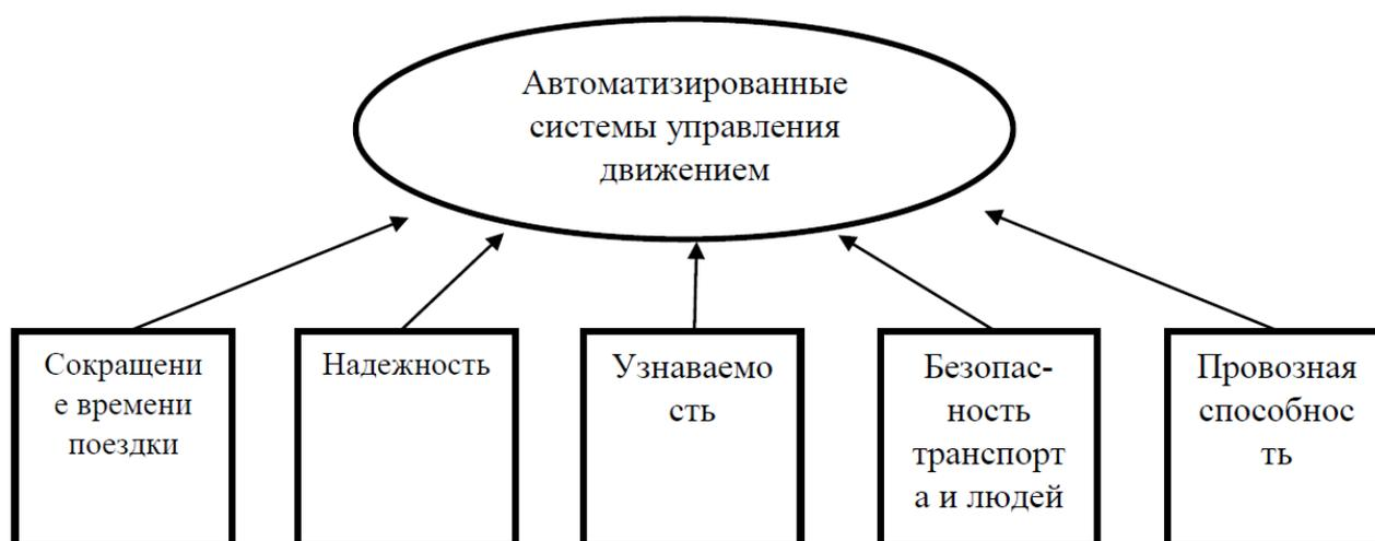
**Рисунок 5 – Влияние отдельных элементов ВРТ на автоматизированные системы управления движением**
